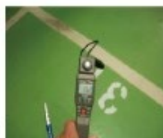
現場照度量測
